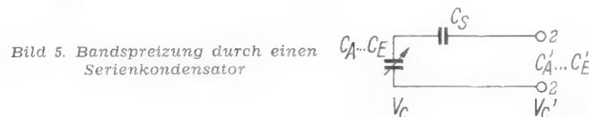
Bild 5. Bandspreizung durch einen Serienkondensator
