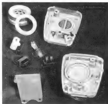
Bild 2. Mikrofon MD 5 mit Schalter und Übertrager in zerlegtem Zustand. Man erkennt folgende Einbauteile: Die Mikrofonkapsel, zwei Auflageringe zur elastischen Lagerung der Kapsel, die Schalterwippe mit eingesetzter Achse, den fertig zusammengebauten Federsatz des Sprechschalters, den Anpassungsübertrager, die Verkleidungsgaze für die Sprechöffnung und die beiden Gehäusehälften
