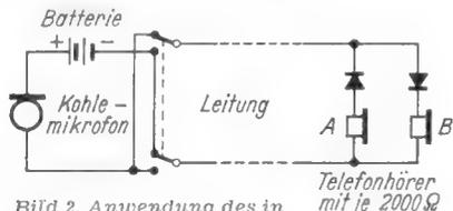
**Bild 2.** Anwendung des in Bild 1 gezeigten Prinzips auf eine Sprechschaltung
